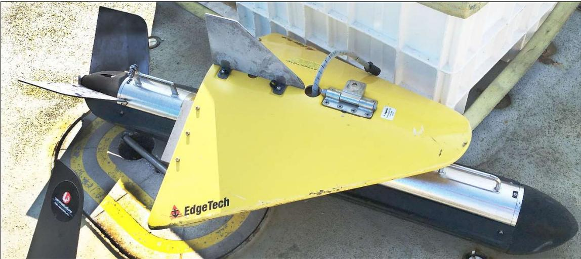
**Photo B-9. Edgetech 4200 side-scan sonar.**
